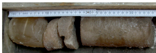
Rys. 21. Sól równokrystaliczna kompleksu \text{Na}_3 + \text{K}_3 + \text{Na}_4
