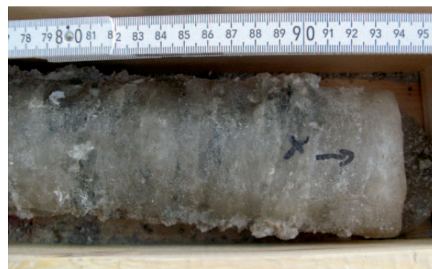
Rys. 11. Sól krystaliczna o zabarwieniu beżowo-szarym ( \text{Na}_2 + \text{K}_2 )
