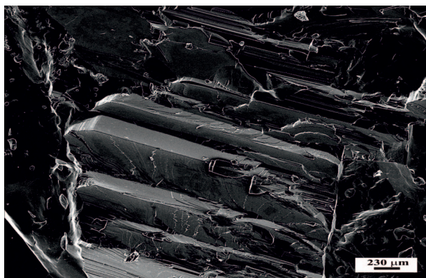
Rys. 15. Duże zazębiające się kryształy halitu (obraz SEM)
