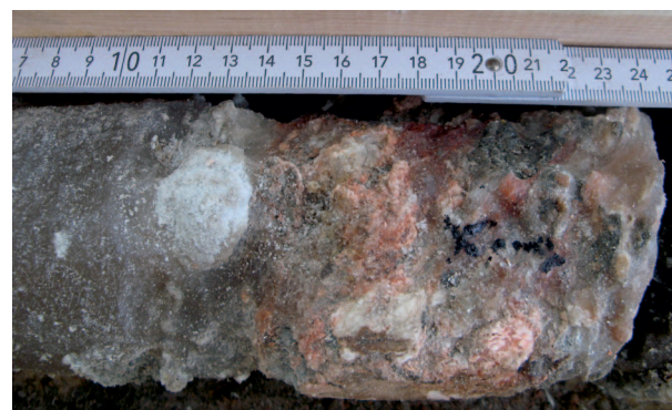
Rys. 12. Sól krystaliczna z gniazdami anhydrytu – strefa wtórnie zmieniona ( \text{Na}_2 + \text{K}_2 )
