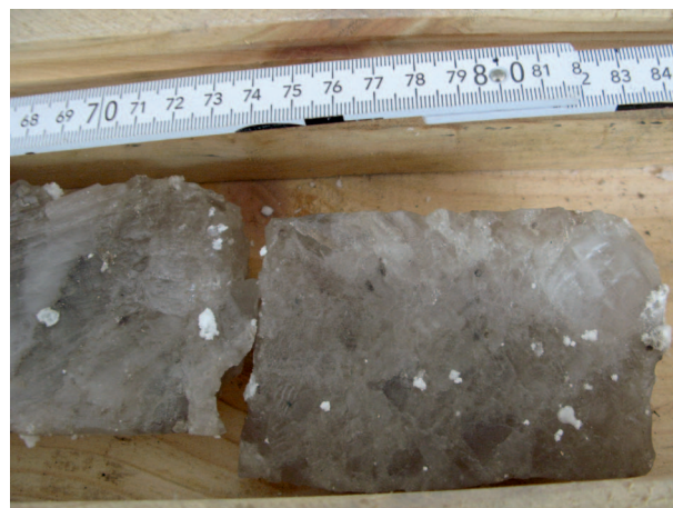
Rys. 2. Dolnomioceńska sól grubokrystaliczna
