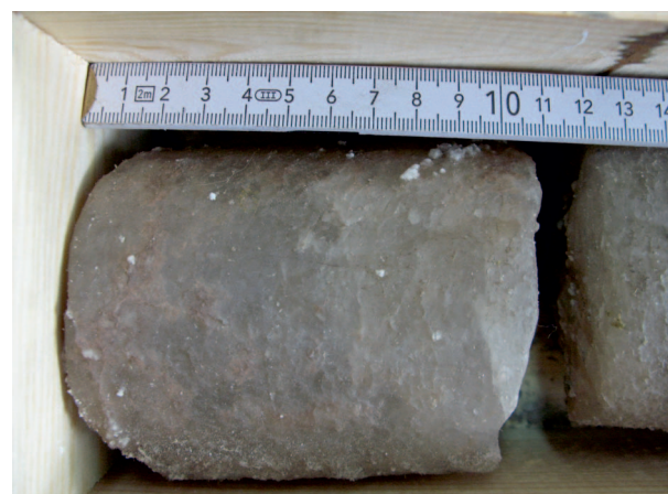
Rys. 22. Sól różnokrystaliczna ogniwa \text{Na}_2
