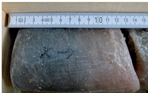
Rys. 10. Sól krystaliczna o zabarwieniu czerwono-brunatnym ( \text{Na}_2 + \text{K}_2 )
