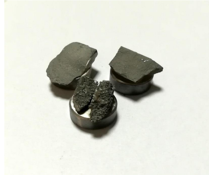
Próbki skał napyłone platyną
