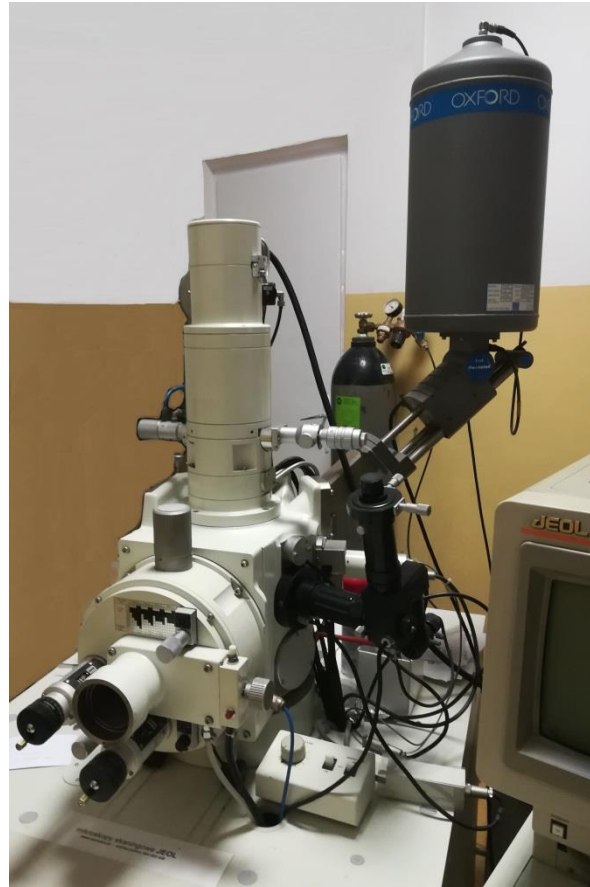
Mikroskop elektronowy skaningowy JSM 6300
